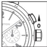
Saat durduktan sonra mekanizmayı tekrar çalıştırmak için elle kurulması önerilir. 0 konumunda: Kurma kolunu saat yönünde 20-30 defa kurun. Ardından mekanizma, bileğin her hareketiyle otomatik olarak kurulur.
