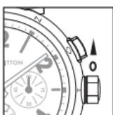
Das Aufziehen von Hand wird empfohlen, wenn sich das Uhrwerk im Stillstand befindet. Hierzu die Krone in der Position 0 ca. 20- bis 30-mal im Uhrzeigersinn drehen. Anschließend zieht sich das Uhrwerk bei jeder Bewegung des Handgelenks automatisch auf.
