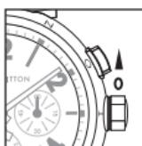
Подзавод вручную рекомендуется для запуска механизма в случае его остановки. Для этого необходимо повернуть заводную головку в положении 0 по часовой стрелке 20–30 раз. В дальнейшем подзавод механизма будет осуществляться автоматически при каждом движении запястья.
