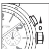
Handmatig opwinden wordt aanbevolen om het uurwerk opnieuw te starten wanneer het stil is komen te staan. In positie 0: wind het horloge op door de kroon 20 tot 30 keer met de klok mee te draaien. Daarna wordt het uurwerk automatisch opgewonden met elke beweging van de pols.
