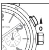
Se recomienda dar cuerda de forma manual para activar el movimiento cuando se ha parado. En la posición 0: basta con girar la corona en el sentido horario (dextrógiro) entre 20 y 30 veces para dar cuerda al reloj. A partir de entonces, la cuerda se activa de forma automática con cada movimiento de la muñeca.
