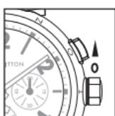
Saat duruktan sonra mekanizmayı tekrar çalıştırmak için elle kurulması önerilir. 0 konumunda: Kurma kolunu saat yönünde 20-30 defa kurun. Ardından mekanizma, bileğin her hareketiyle otomatik olarak kurulur.
