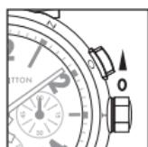
Συνιστάται χειροκίνητο κούρδισμα για την επανέναρξη της κίνησης όταν αυτή έχει σταματήσει. Στη θέση 0: το κούρδισμα πραγματοποιείται γυριζόντας την κορόνα δεξιόστροφα 20 με 30 φορές. Η κίνηση επανέρχεται αυτόματα στη συνέχεια με κάθε κίνηση του καρπού.
