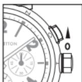
Pokud se hodinový strojek zastaví, doporučujeme ho znova spustit ručním natažením. Hodinky se natahují v poloze 0 tak, že otočíte 20× až 30× korunkou ve směru hodinových ručiček. Hodinky se potom natahují automaticky při každém pohybu zápěstí.
