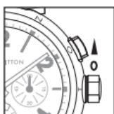
La carica manuale serve a riattivare il movimento quando si arresta. In posizione 0: per caricare, girare la corona in senso orario 20-30 volte. L'orologio si carica automaticamente a ogni movimento del polso.
