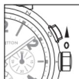
بعض الساعات مجهزة بتاج ولوبي التثبيت. يجب حلّ التاج اللولبي قبل القيام بأي عملية تعبئة يدوية كما يجب إعادة إحكام تثبيت التاج بعد استخدامه في كلّ مَرَّة من أجل ضمان مقاومة الساعة لتسرب الماء.
