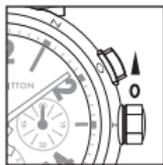
Se recomienda dar cuerda de forma manual para activar el movimiento cuando se ha parado. En la posición 0: basta con girar la corona en el sentido horario (dextrógiro) entre 20 y 30 veces para dar cuerda al reloj. A partir de entonces, la cuerda se activa de forma automática con cada movimiento de la muñeca.
