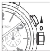
机芯完全停止时，建议以手动方式为机芯上链。于位置 0 将表冠朝顺时针方向转动 20 至 30 次。之后，机芯便会随着手腕的摆动自动上链。
