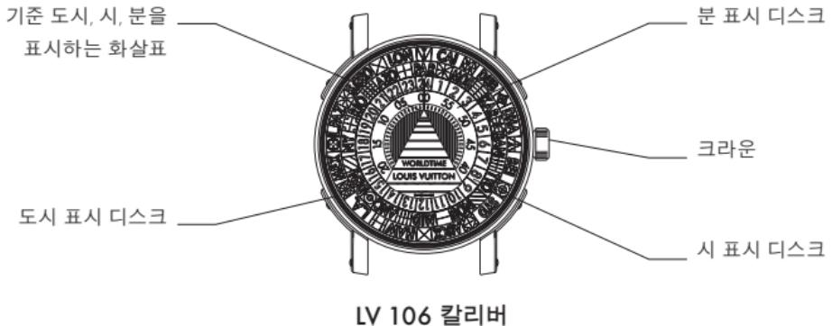
현재 타임존의 시간은 3개의 디스크(도시 표시 디스크, 시간 표시 디스크, 분 표시 디스크)를 가리키는 화살표로 읽습니다. 다른 23개 타임존의 시간은 해당 도시와 일직선에 있는 시간 표시 디스크로 읽습니다.
